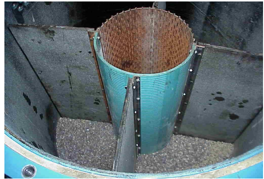
Innenansicht URSEL: 4 Quadranten, Brunnenfilterrohr zweigeteilt (PVC-Schlitzfilter & Stahl-Schlitzbrückenfilter)
