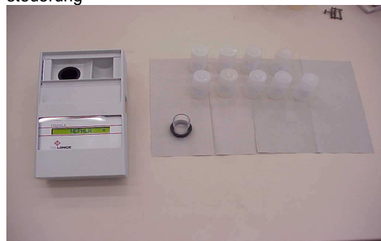
Trübungsmessgerät mit Küvette und Probenbehältern
