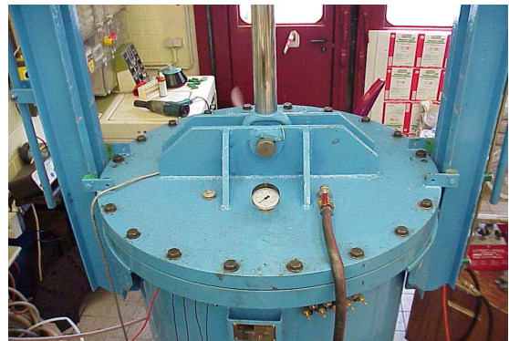
fertige Anlage geschlossen mit Sicherheitschrauben, Manometer und Ablaufschlauch oben
